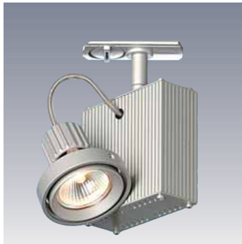
Hugin spotlight, 1 x Gu5,3, 12V max. 50W. Innebygget trafo. Rotérbar 355°, tiltbar 90°. P340893 satin/alum. farget
