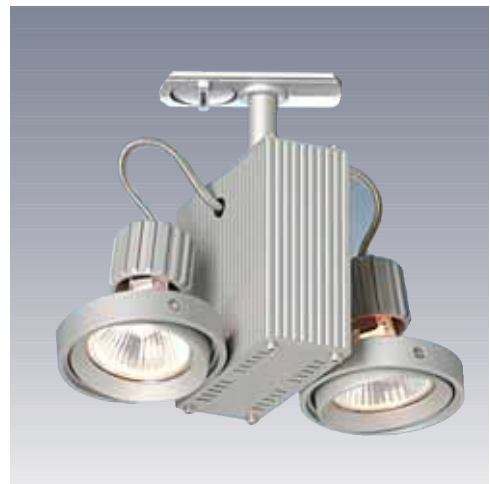
Hugin spotlight, 2 x Gu5,3, 12V max. 2 x 50W. Innebygget trafo. Rotérbar 355°, tiltbar 90°. P340993 satin/alum. farget
