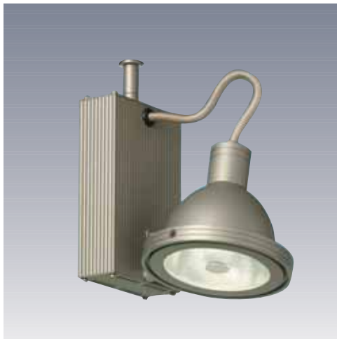
Ymir lyskaster, G 12, 70W metallhalogen Rotérbar 355°, tiltbar 90°. H 228 x B 165 mm P340493 satin/alum.
