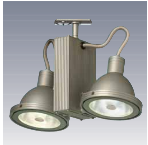
Ymir dobbel lyskaster, G 12, 2 x 35W, metallhalogen Rotérbar 355°, tiltbar 90°. H 228 x B 286 mm P340593 satin/alum.
